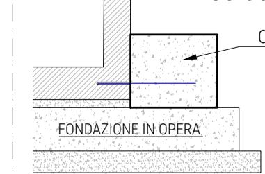
N.B.: Nei casi in cui la presenza di una falda freatica in situ non consenta la verifica dello stato limite SLU-UPL, è possibile ricorrere a presidi antigalleggiamento da verificarsi di volta in volta.
